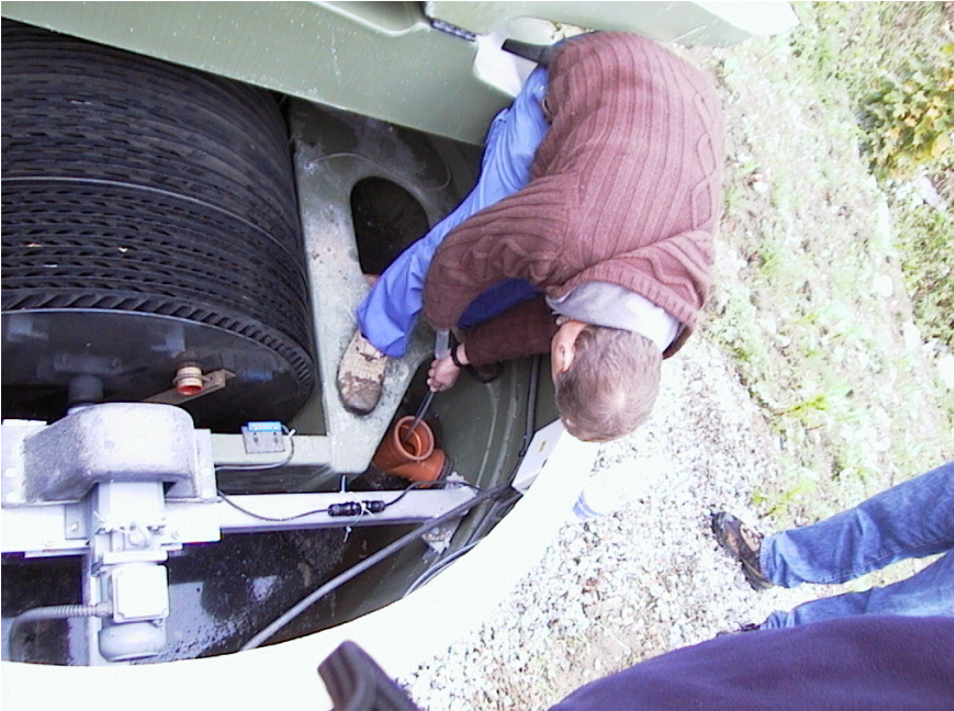
Figur 7. Uttak av stikkprøve fra et Klargester anlegg.
