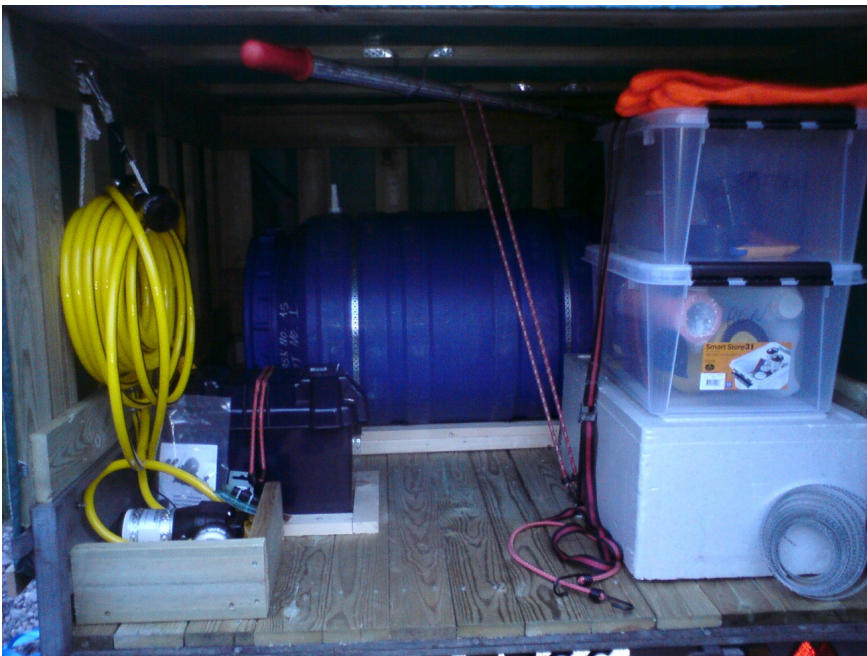
Figur 2. Tilhenger innredet med nødvendig utstyr for rengjøring av prøvetakingsutstyr.
