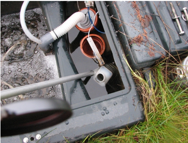
Figur 5. Uttak av stikkprøve ved et WehoMini anlegg.
