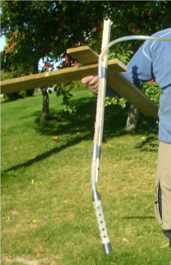
Figur 15. Spesialstativ for uttak av blandprøver fra Odin anlegg. Sugelangse med lodd er festet til vertikal stav av tre.
