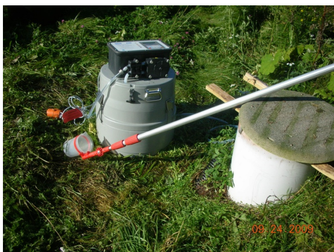
Figur 21. Portabel prøvetaker type Isco klargjort for uttak av blandprøver fra Wallax anlegg.
