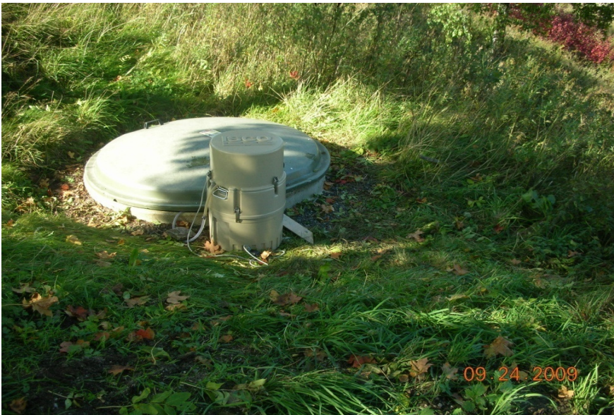
Figur 1. Portabel automatisk prøvetaker (type Isco) montert for uttak av døgnblandprøve.
