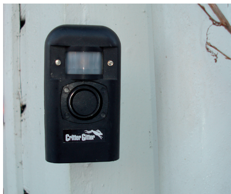
«Crittter Gitter» monteres slik at dyrets bevegelser utløser skremselslyd.
