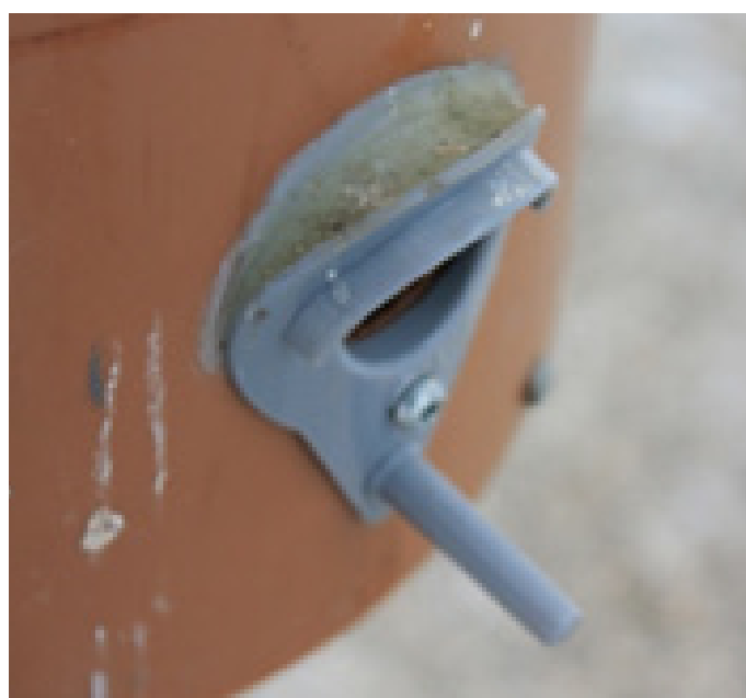
Prototypen av plastrøret som ble benyttet som fôringsautomat høsten 2012 (oppe, venstre) og den justerte versjonen brukt i 2013 basert på erfaringene så langt (nede, venstre). Festeanordningen til treet (oppe, høyre) og den endelige utformingen av fôringshullene (nede, høyre) er også vist på bildene.
