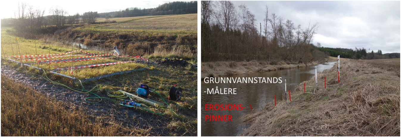
Figur 3. Feltforsøk. Bilde til venstre: Simulering av overflateavrenning gjennom kantsoner med gras. Bilde til høyre: måling av grunnvannstand og kanterrosjon (foto: A-G.B. Blankenberg)
