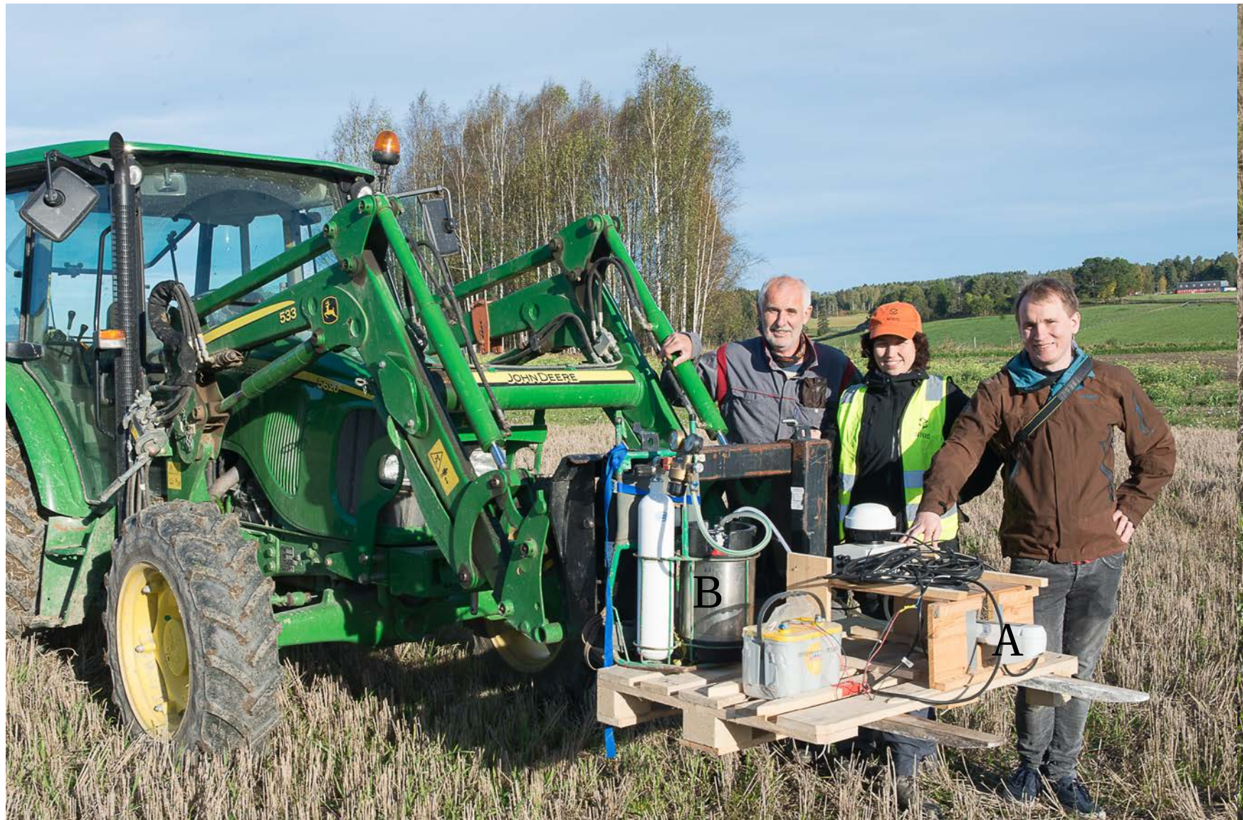
FIGUR 2. Sprøytingen med WeedSeeker ble utført med lesseapparatet som bærer av WeedSeeker (A), tank med glyfosat (B), gps-antenne (C). Dysen var ca. 65 cm over kornbestandet (forsøk i gulmoden bygg) eller bakken (forsøkene i stubb). Fra venstre: Kjell Wærnhus, Therese With Berge og Torgir A. Lien. Foto: Erling Fløistad.
