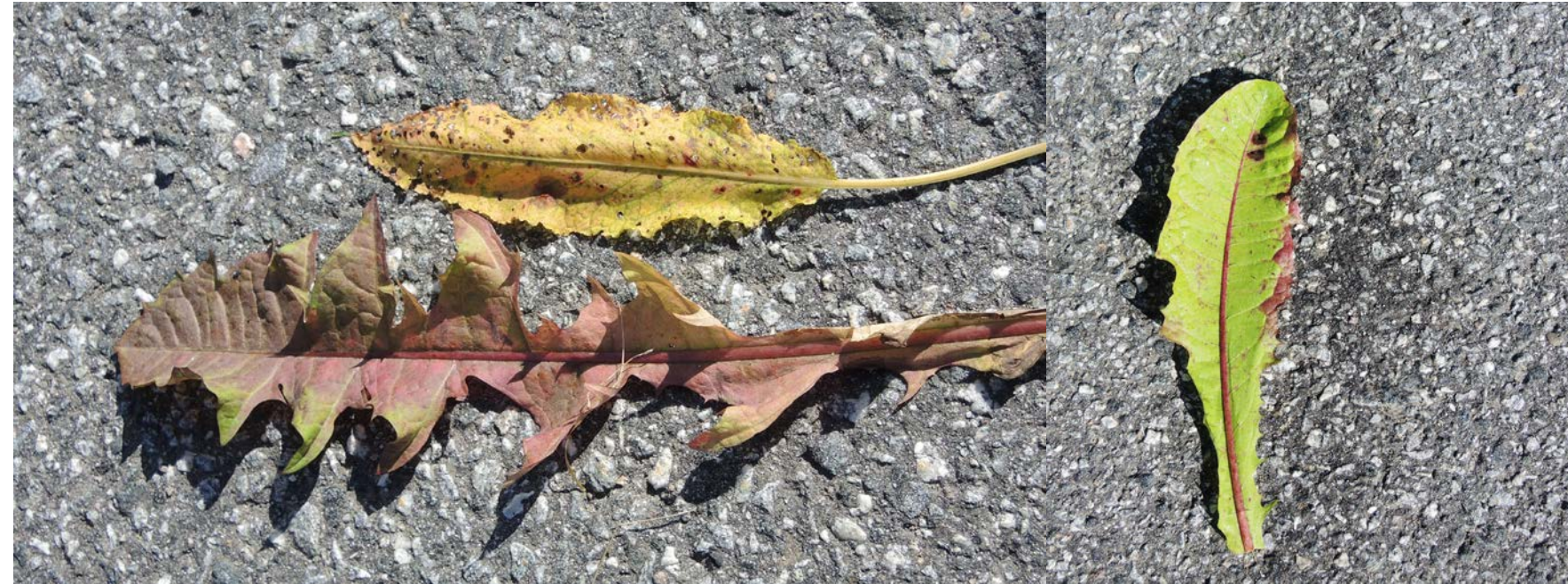
FIGUR 3. Den aller første testinga av WeedSeeker ble utført på asfalt. Det var kun vann på tanken og løvetannblad med ulik grad av naturlig gulning ble lagt på bakken like før vi dro riggen med WeedSeeker over bladene. De to bladene til venstre triggert ikke dysen til åpne. Bladet til høyre triggert dysen til å åpne (Legg merke til vått område til høyre for bladet). Foto: Therese W. Berge.
