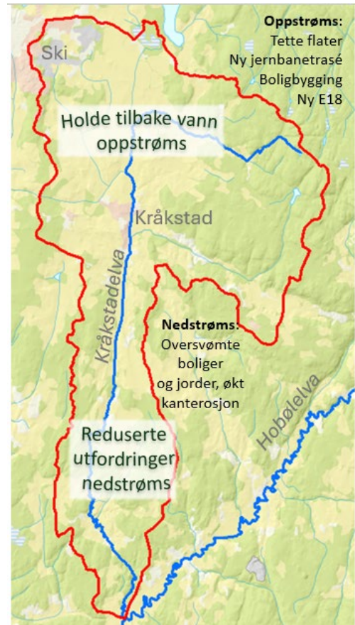
Kråkstadelvas nedbørfelt. Kartet skisserer noen utfordringer og mulige løsninger som prosjektet vil arbeide med.
