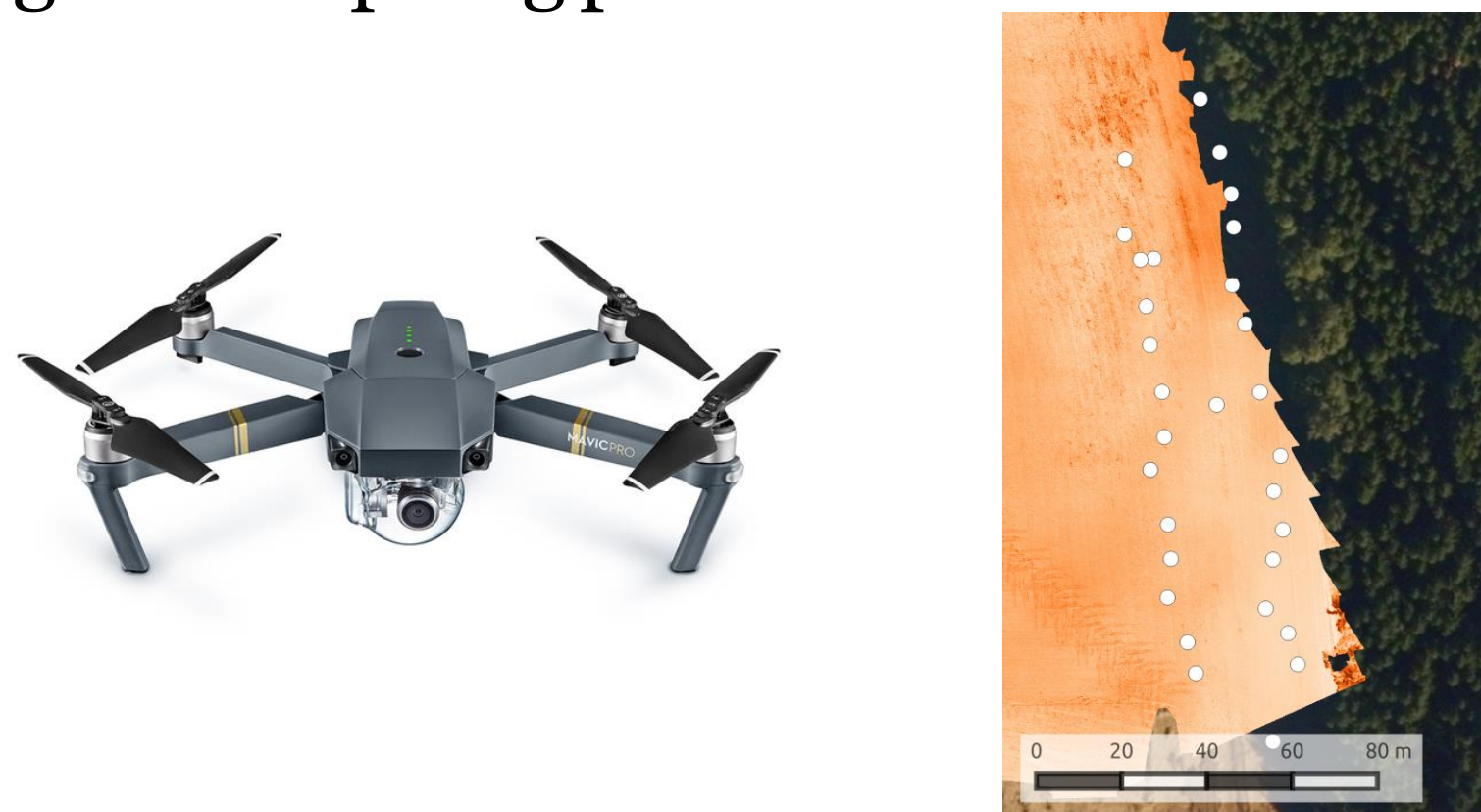
Bilde 3: UAV og indikativt kart med vanninnhold og prøvepunkt.
