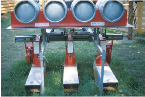
Traktormontert flammeutstyr for flammning over gulrot sengene eller mellom radene. (Foto: J. Netland)
